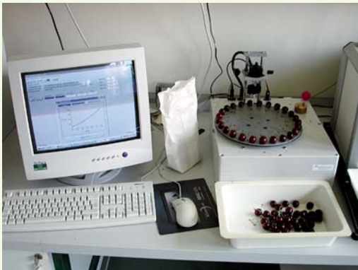
Arbeitsplatz für physikochemische Fruchtanalysen, hier Festigkeitsmessung bei Kirsche
